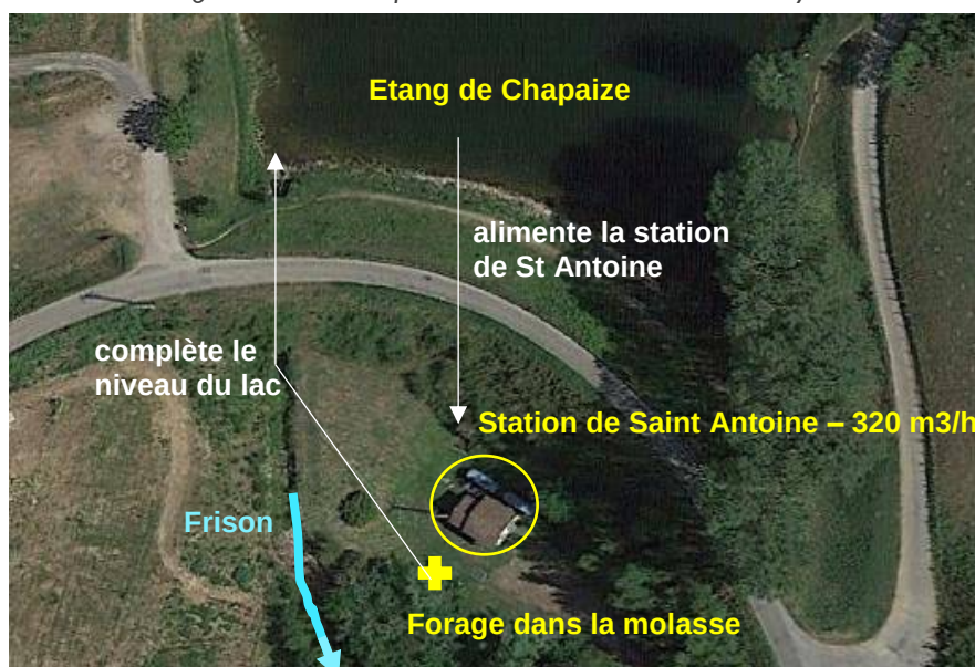
Figure 14 : Site de production de Saint-Antoine l'Abbaye
